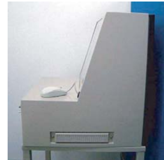
画面に適度な傾斜をつけることにより、ディスプレイを見やすい状態を保つことに成功しました。
